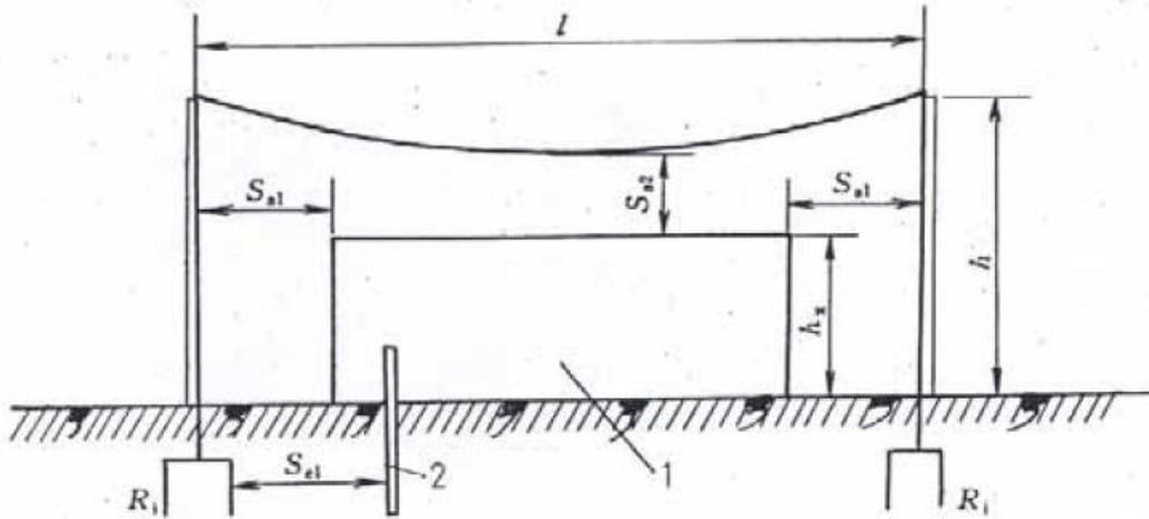
图 4.2.1 防雷装置至被保护物的间隔距离
