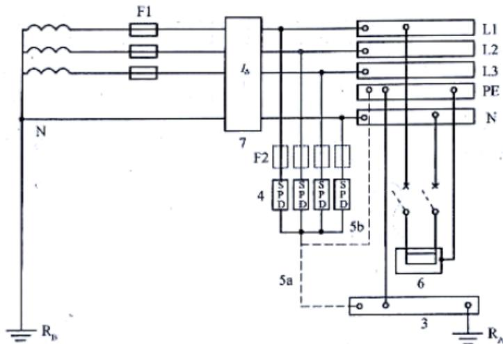
图 J.1.2-1 TT 系统电涌保护器安装在进户处剩余电流保护器的负荷侧
