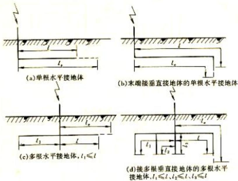
图 C.0.2 接地体有效长度的计量
